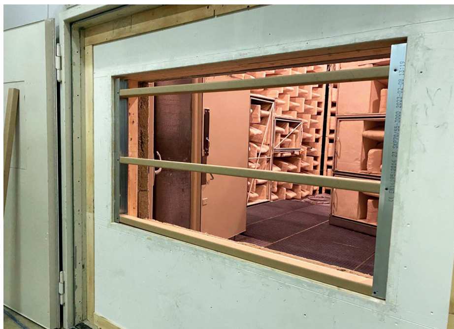
Figur 5: Konstruktionen med pappreglar monterade i öppningen.
