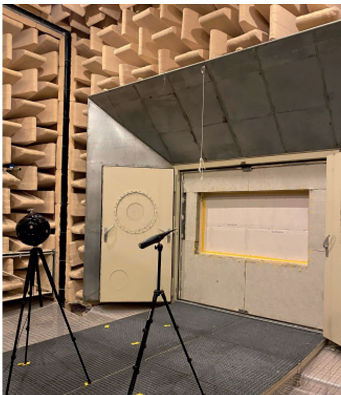
Figur 6: Mätning av ljudtrycksnivå i efterklangsrummet.
