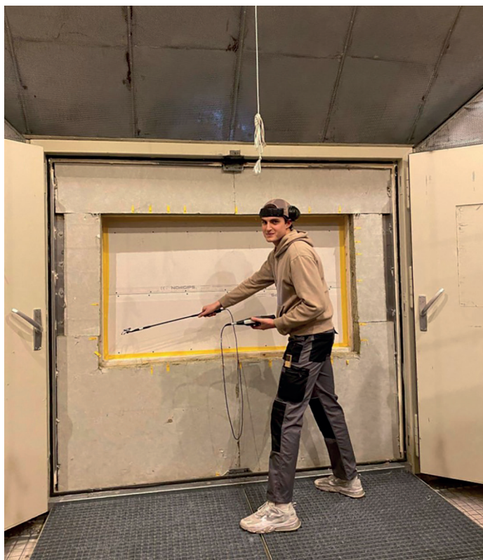
Figur 7: Mätning av ljudintensitet i det ekofria rummet.
